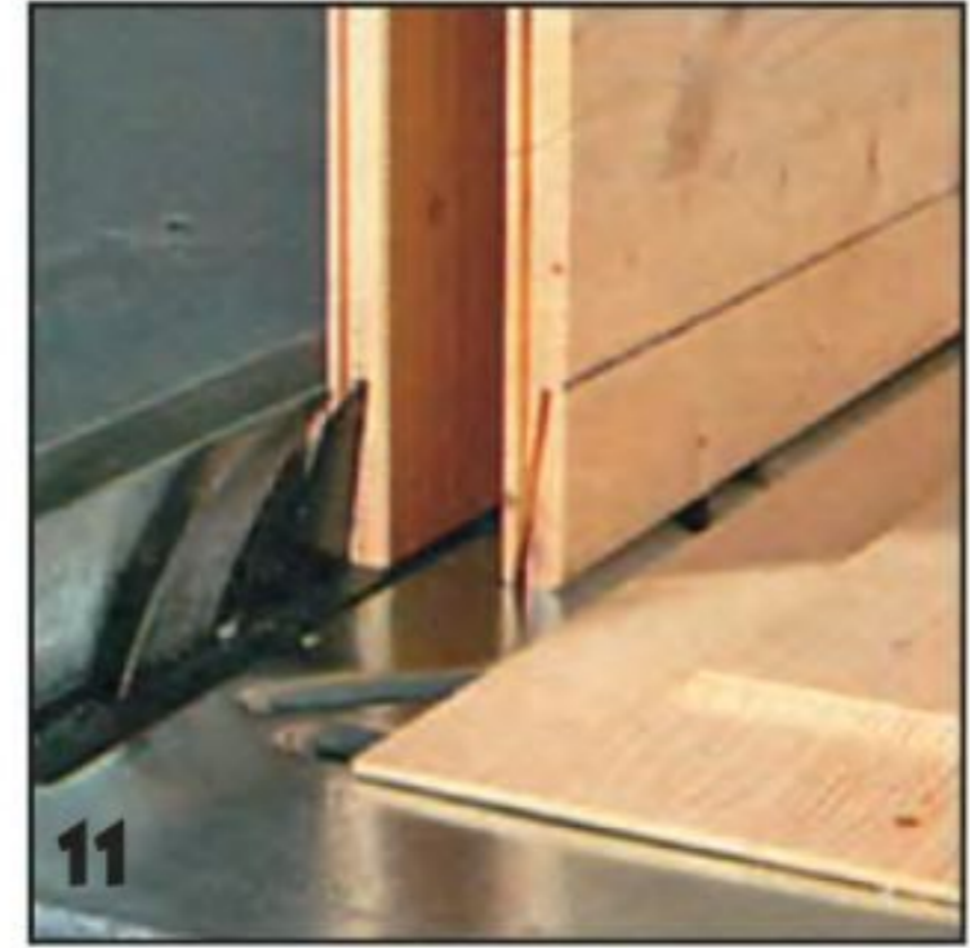
11 Чтобы сформировать скосы на филёнках, в их кромках делают пропил соответствующей глубины. Затем, сделав неглубокий пропил с лицевой стороны, отделяют получившийся клин.
