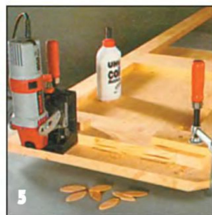
5 В крышке, дне и в кромках рам фрезой выбирают пазы под шпонки.
