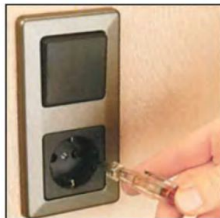
Наличие напряжения в розетке можно проверить индикатором напряжения или тестером.
