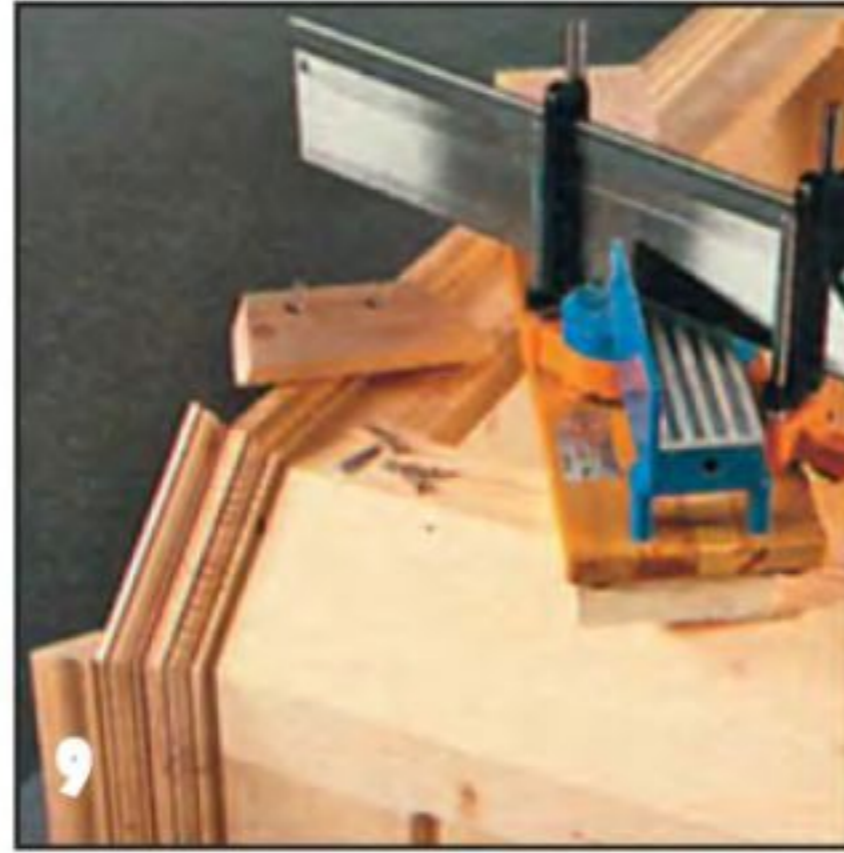
9 Профилированные накладки запиливают «на ус» и прикручивают шурупами к крышке.
