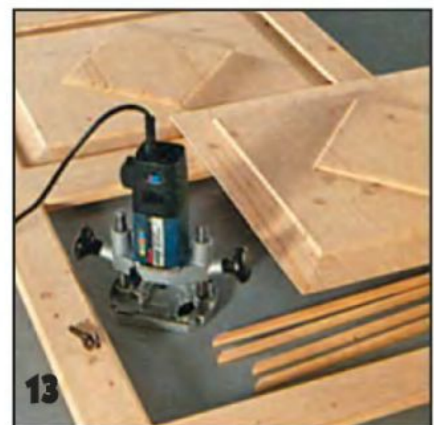
13 Прежде чем вставить филёнки, наружные кромки вырезов рам скругляют фрезой.
