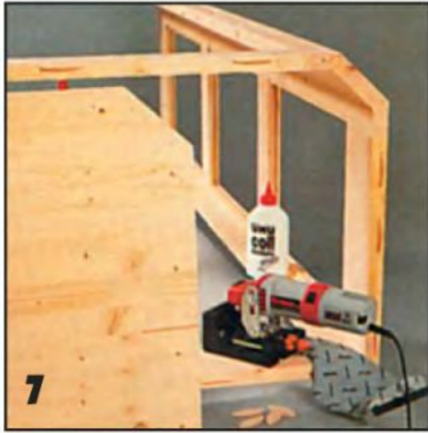
7 Крышку и дно соединяют на плоских шпонках с клеем и усиливают соединения шурупами.
