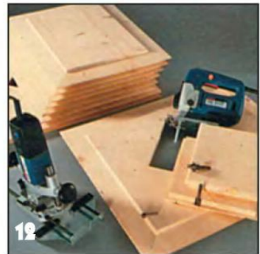
12 Филёнки для дверки украшают дополнительными вставками. Кромки вставок с одной (лицевой) стороны скругляют, а с другой — выбирают фальц.
