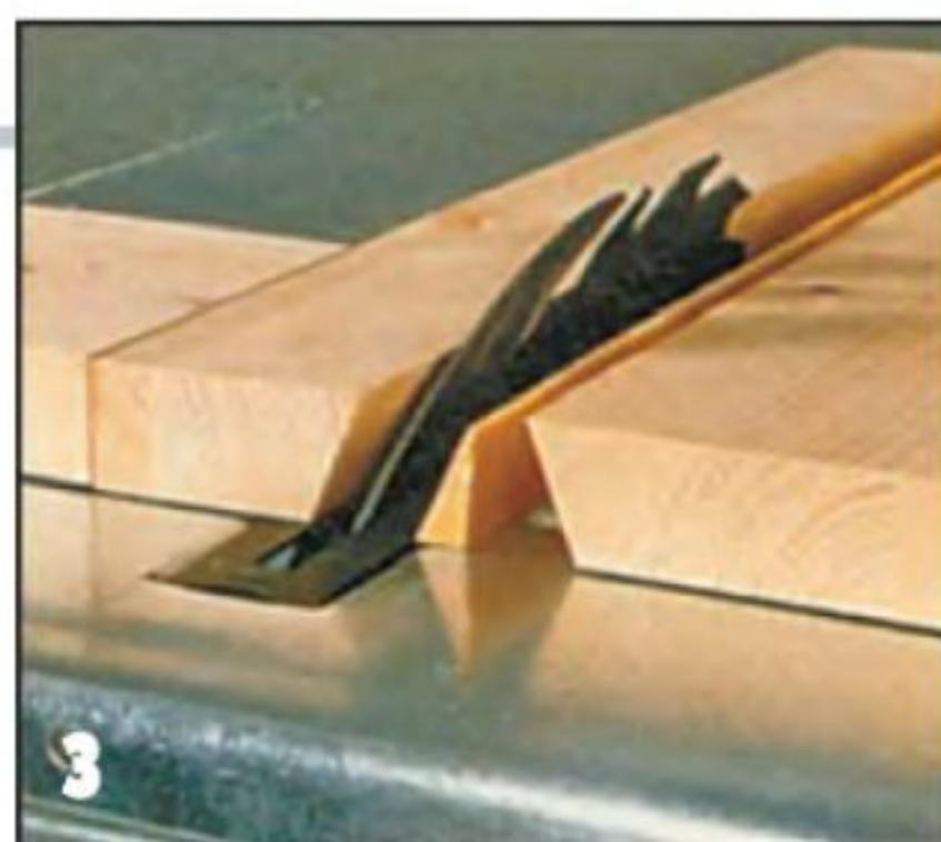
3 Чтобы соединить детали под углом в 135^\circ , кромки вертикальных угловых вставок и передние кромки собранных рам запиливают под углом 22,5^\circ .
