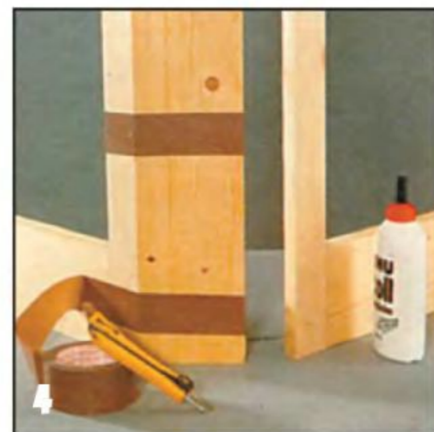
4 Боковые рамы и скошенную угловую вставку склеивают друг с другом впритык, временно скрепляя их туго натянутой самоклеящейся лентой.
